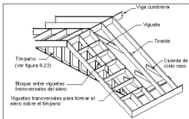
FIGURA 57 – VIGUETAS TRANSVERSALES EN ALERO SOBRE TÍMPANO
